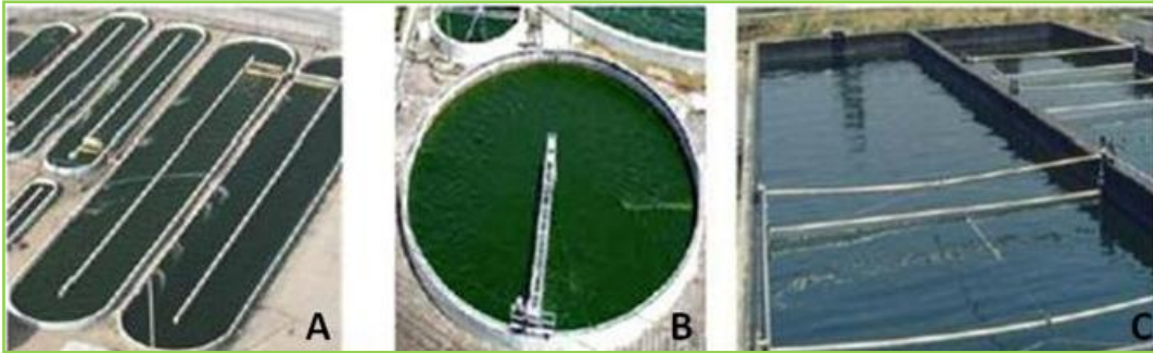
Figura 1.6. Sistemas de cultivo abiertos: A) Tanques tipo canales; B) Tanques circulares; C) Tanques sin agitación. Adaptado de Chen et al. , (2009)
