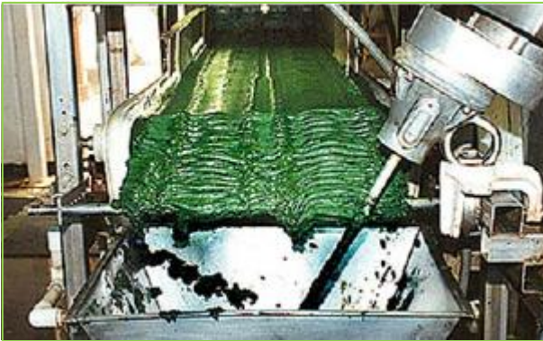
Figura 1.8. Pasta de microalga separada de su medio de cultivo en una cinta transportadora. Pertenece a Cyanotech Corporation y adaptada desde Chisti, (2007)
