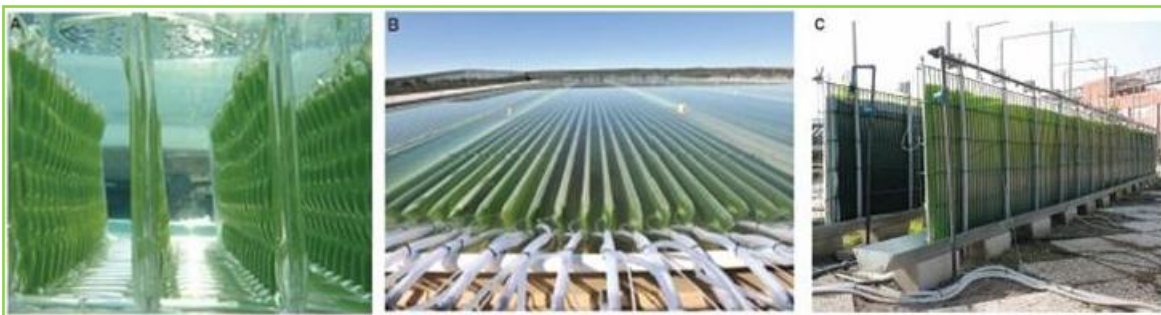
Figura 1.7. Sistemas de cultivo tipo fotobiorreactores de paneles: A) sumergidos, prototipo de Bélgica. B) sumergidos, prototipo de USA. C) Paneles verdes, prototipo de Italia. Adaptado de Wijffels & Barbosa (2010).
