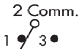
Figura 46 Esquema Interruptor Deslizante
