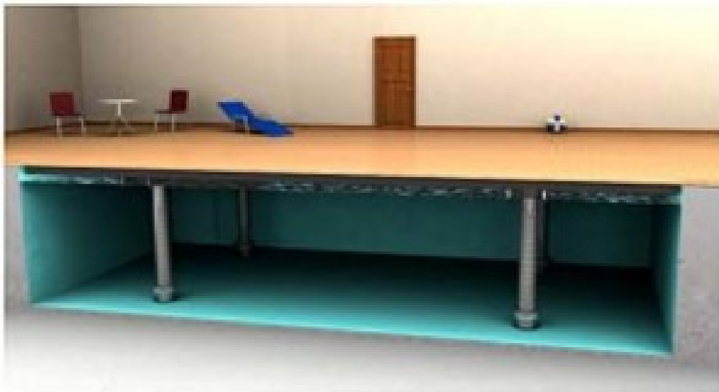
Figura 40 - Cobertura já elevada, após entrada das sustentações (Silva, 2018)
