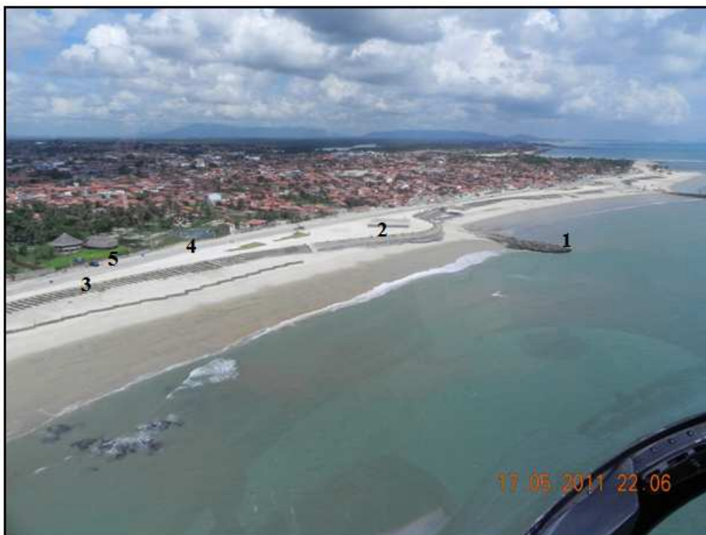
Figura 6.15 – Imagem de um trecho da costa oeste requalificado pela PMF. Em pouco mais de 4 km de orla foram construídos novos espigões (1) e muros de proteção (2); foi feita a fixação da pós-praia (3); e foi construído um calçadão (4) e uma via de acesso costeira (5). Foto: SEMACE, 2011.
