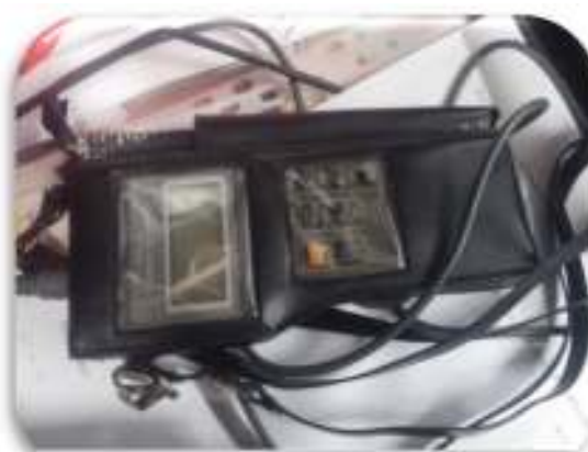
Figura 9 – Medidor de temperatura e humidade
