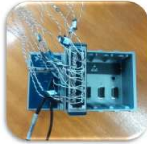
Figura 11 – Montagem dos termopares no módulo de aquisição de dados
