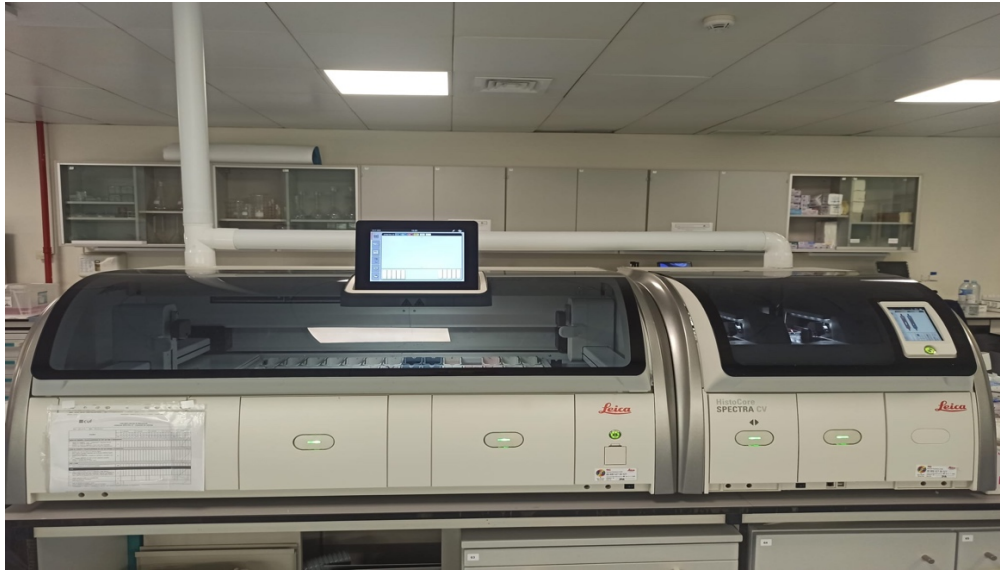
Figura 9: Estação de trabalho Leica do modelo HistoCore SPECTRA CV. Esta estação, pertence ao laboratório da unidade de anatomia patológica do hospital CUF Descobertas, sendo utilizada para realizar colorações de HE.
