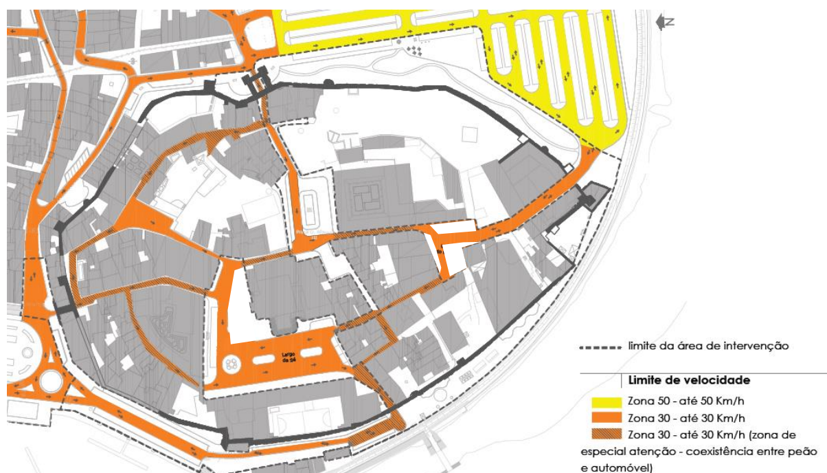
Figura 6.22 - Identificação em planta dos limites de velocidade.
