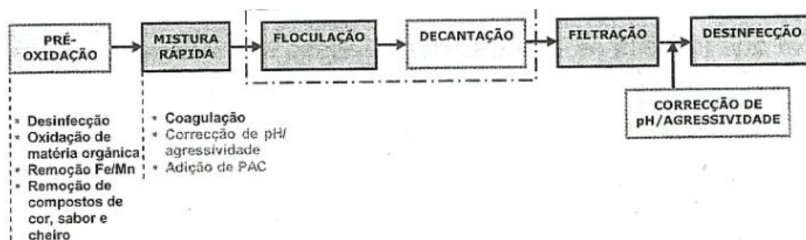
Figura 6 – Esquema-tipo de tratamento de água de origem superficial em Portugal
