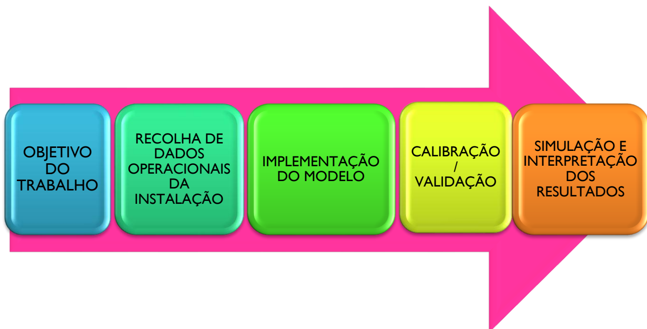
Figura 3.1 – Esquema da metodologia adotada para aplicação de modelo matemático (adaptado de IWA, 2014)
