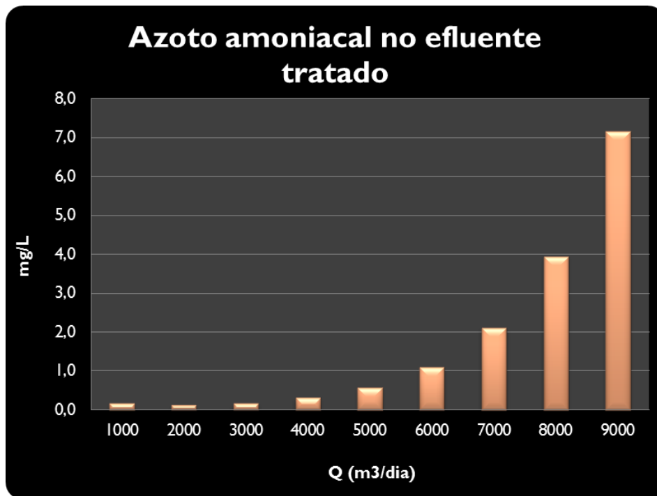
Figura 5.1.6 - Evolução do azoto amoniacal no efluente tratado da ETAR de Albufeira Poente em função do caudal afluente com reconfiguração do reator biológico (1 tanox+3taer)
