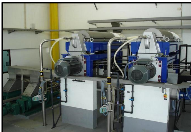
Figura 3.1.11 – Fase sólida – Desidratação mecânica por centrifugação
