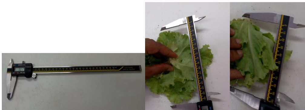
ILUSTRAÇÃO 9-6 Medições com paquímetro digital
