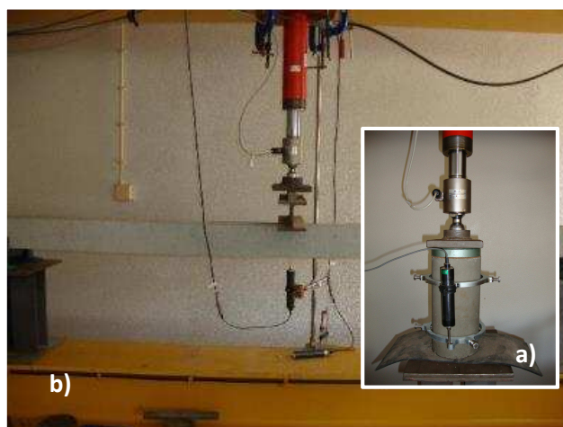
Figura 5.3 – Ensaio de medição do módulo de elasticidade (a) Ensaio de provete cilíndrico (b) Ensaio da viga simplesmente apoiada
