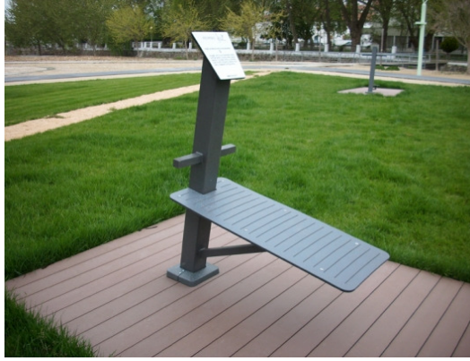
Figura 11: Máquina geriátrica assente em compósito 100% reciclado.
