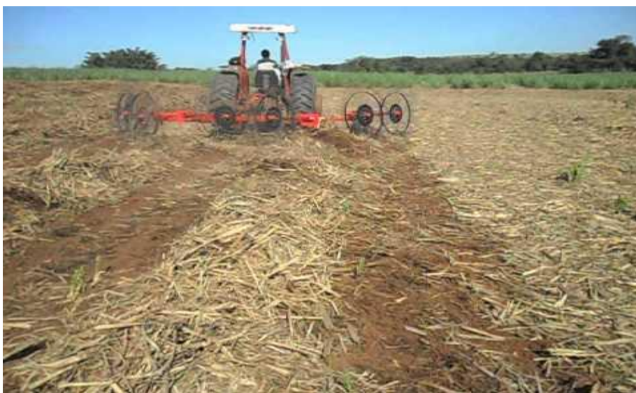
Figura 3.11 - Ilustração da operação de enleiramento. Fonte: Stabra (2005)
