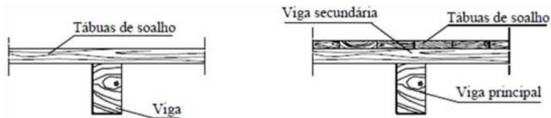
Fig. 3.2– Pavimentos com e sem viga secundária. (Martins, 2010)
