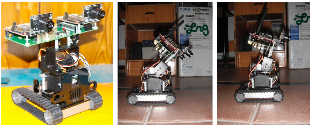
Figura 3.1: À esquerda o robô SRV-1 com sistema de visão stereo , ao centro o robô na posição P1 e à direita na posição P2(ver texto para mais detalhes).
