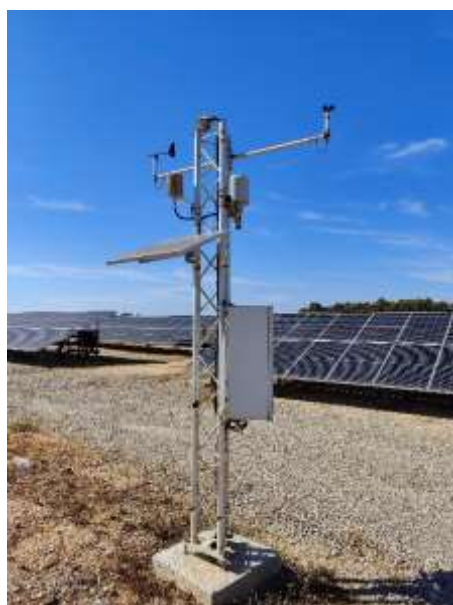
Figura 3.16 - Estação metrológica da CF do AGC.
