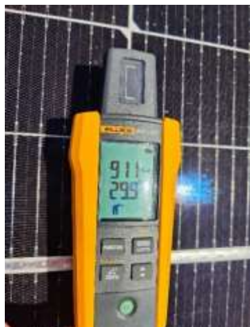
Figura 3.52 - Display com informação de temperatura do painel e radiação solar.
