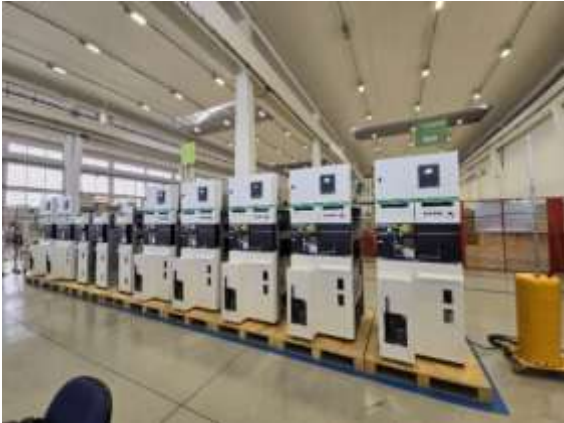
Figura 2.5 - Imagem das 10 celas de MT durante os ensaios.
