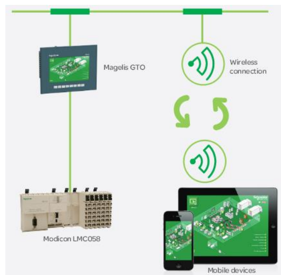
Figura 1.8 - Arquitetura usada pela aplicação “Vijeo design'Air” [6]
