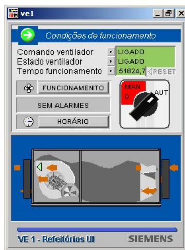
Figura 40 - Ventilador de extração nº1 [5]
