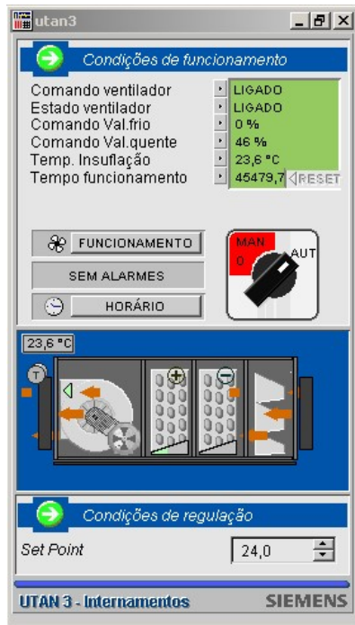
Figura 38 - Condições funcionamento UTAN nº3 [5]
