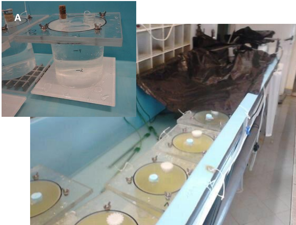
Fig. 5. Tanque com as câmaras utilizadas na realização dos ensaios. (A) Câmaras de acrílico de 5.5 L (Respirômetros).
