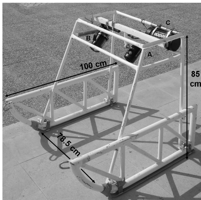
Figura 1 - Dispositivo de amostragem por vídeo subaquático onde se pode observar, o trenó de arraste e as suas medidas, a câmara subaquática (a) , a luz artificial (b) e a sua bateria (c) .
