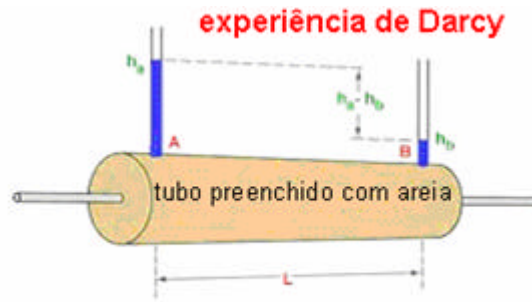
Figura 6. Esquema da experiência de Darcy (Fonte: http://www.uwsp.edu/water/portage/undrstnd/gwmove.htm )
