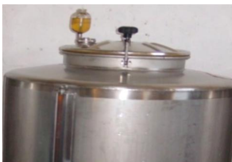
Figura 1 – Fermentador fechado com válvula de saída de gás (dióxido de carbono)
