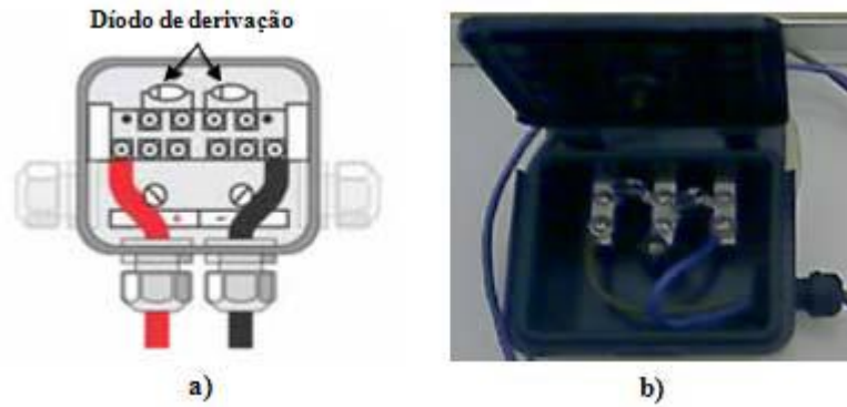
Figura 3.19 a) – Modelo da caixa de junção com díodo de derivação b) Caixa de um módulo (fonte: FER, ALTENER, 2004)
