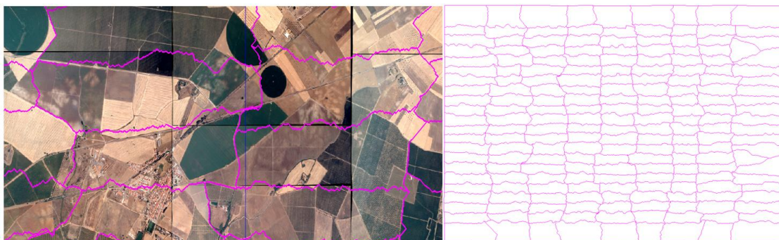
Figura 3.36 – “ Seamlines ” obtidas pelo “ Smart Seams ” (Fonte: ISOP, 2021).
