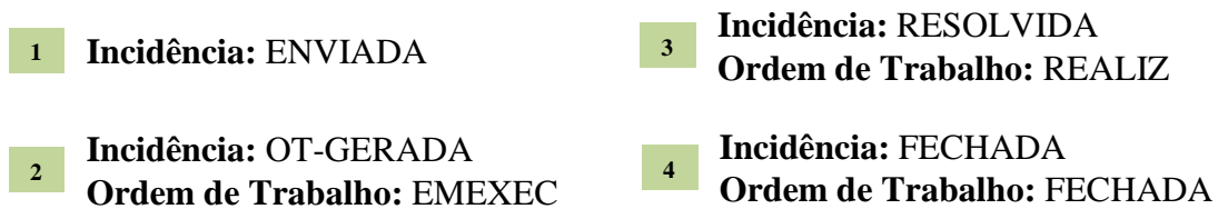
Figura 24 – Pontos de situação manutenção corretiva (AFR) (Documentação e Manuais SGM ANA,SA, 2011)
