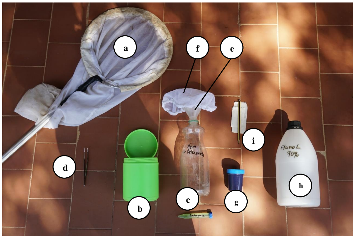
Figura 3.2 - Material para amostragens com sweep : rede de varredura (a), recipiente fechado (b), garrafa com água e detergente (c), pinça (d), funil (e), pano tipo musseline (f), copo de amostragem (g), etanol(h) e material de etiquetagem (i)
