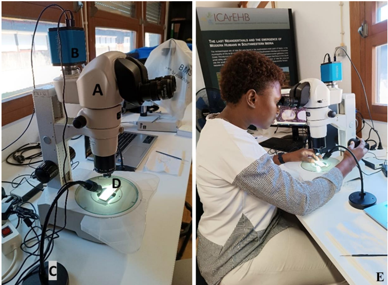
Figura 3: Microscópio binocular Nikoni-SMZ 800N (A); Camara XM Full HD (B); Iluminação (C); slide com as valvas de ostracodes (D); manipulação do microscópio e da luz para obtenção das fotografias (E) (Fonte: Patrícia Simão, 2024).
