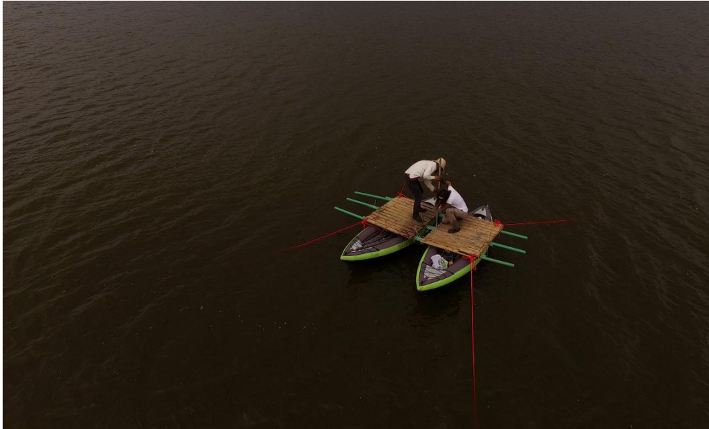
Figura 2: Representação da extracção dos sedimentos no nível mais profundo do lago, com uma jangada e um Piston Livingstone (fotografia InMoz 2019).
