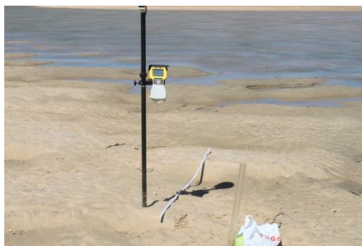
Figura 4.6: Medição de estruturas sedimentares. Direção das cristas e medição e direção dos sentidos de fluxos.
