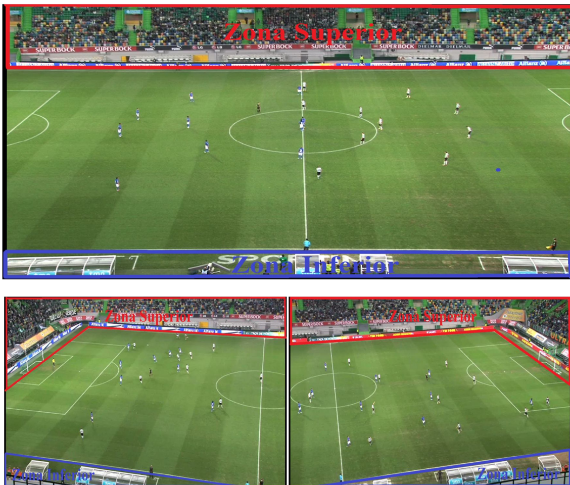
Figura 3.1.3 – Identificação das zonas a eliminar (exteriores ao recinto de jogo), zona superior encontra-se delimitada a vermelho e a zona inferior, a azul.
