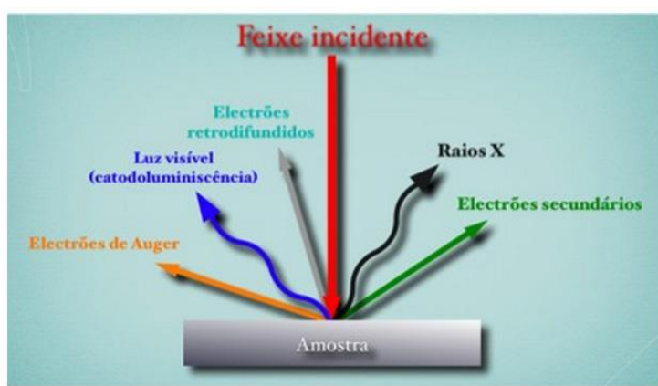
Figura 5 - Sinais gerados, numa análise de SEM, quando os elétrons colidem com a amostra.
