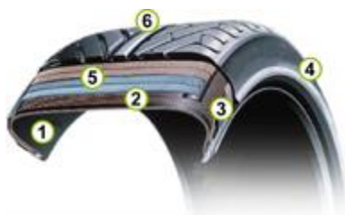
Figura 26 - Constituição do pneu.
