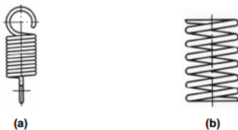
Figura 8 - Molas helicoidais: (a) e molas de tracção (Mendes, 2003).
