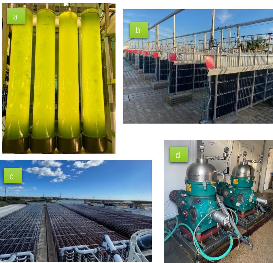
Figura 10 – Fotografias dos equipamentos utilizados para fazer o processo scale-up e por fim a centrifugação. (a) Bubble column ; (b) Green Walls/ flat pannel ; (c) - Fotobiorreatores Tubulares; (d) Centrifugas.
