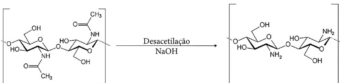
Figura 1.6 – Processo de desacetilação de quitina. Adaptado de (72).
