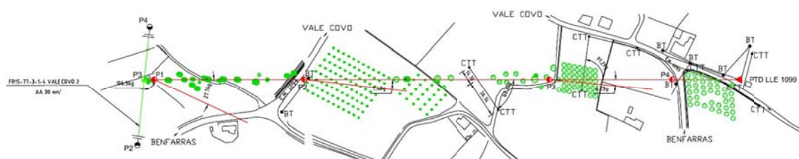
Figura 30 - Perfil da Linha Aérea de Média Tensão
