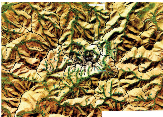
Fig. 4 O sistema hidroagrícola de Zraoua. Reconstituição da paisagem de produção dos jessour . 1 Zraoua implantada na linha de festo (a tracejado) 2 jessour (a verde) 3 tabia 4 cisternas (concentradas em redor da povoação)
