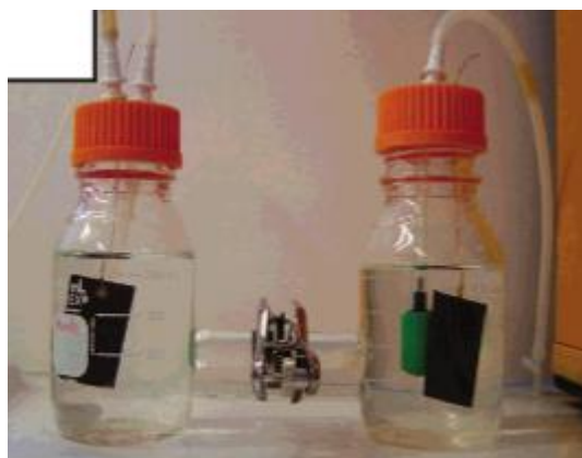
Figura 4: Sistema de forma "H" com duas câmaras, onde é possível observar as câmaras anódica e catódica equipadas com pulverização de gás. (Adaptado de Logan et al., 2006)
