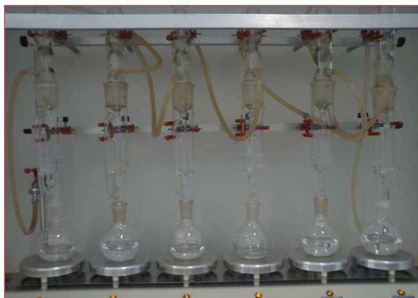
Figura 5: Análise de extrato etéreo por extração direta em Soxhlet.
