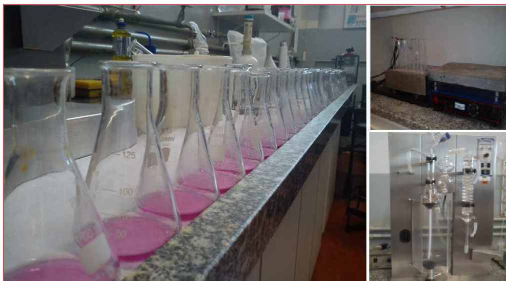
Figura 4: Análise de proteína bruta pelo método de Kjeldahl clássico.
