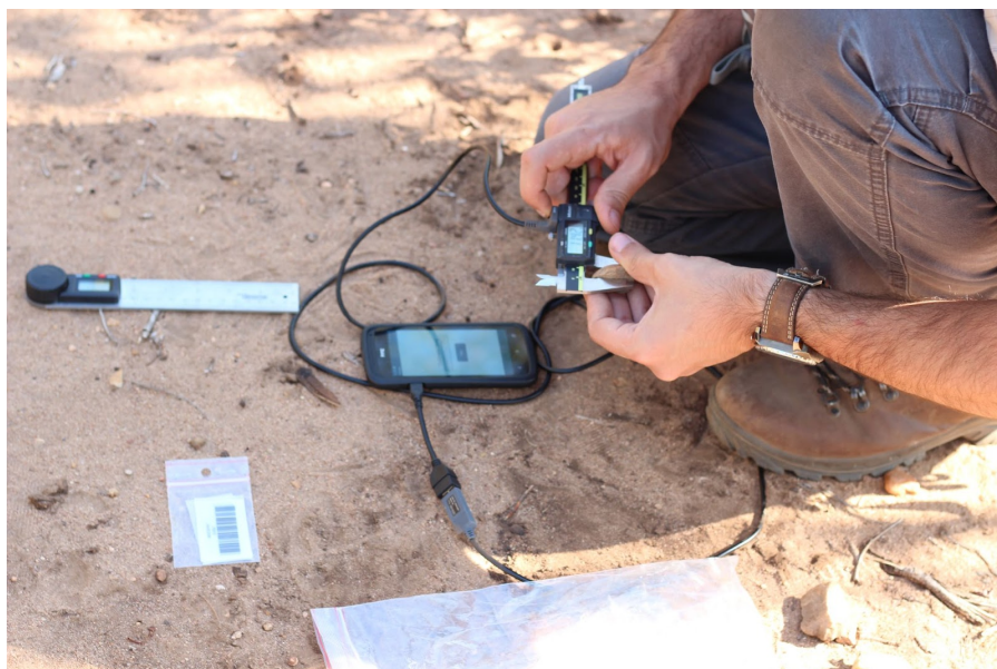
Figura 5. Exemplo de utilização de um paquímetro digital conectado diretamente a um smartphone para recolha de dados de indústrias líticas durante o trabalho de campo.
