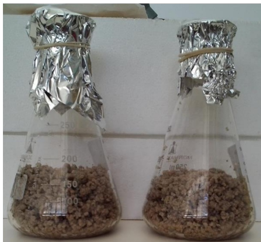
Figura 3.15: Foto dos ensaios em erlenmeyer no início do processo SSF de lamas primárias com uma carga de 150 g/L de hidratos de carbono.
