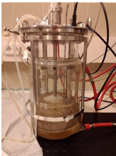
Figura 3.19: Foto do biorreator no início do processo SSF em regime descontínuo a 38°C.
