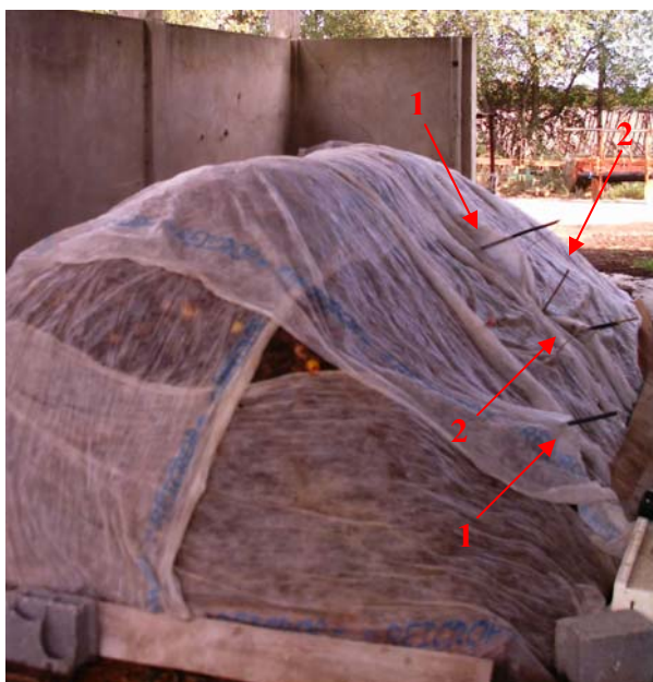
Figura 8: Sondas de temperatura, sendo: 1- sondas laterais, 2 – sondas centrais
