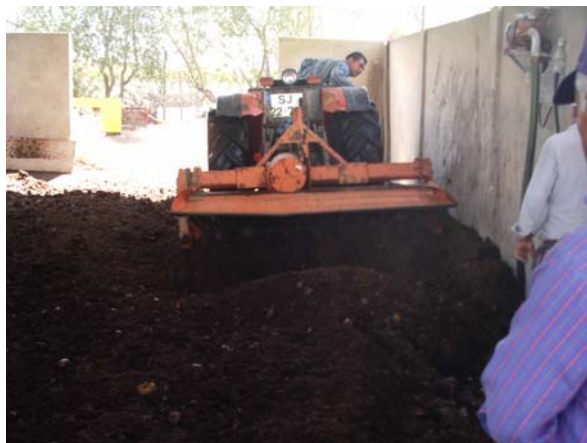
Figura 7: Reviramento com fraccionamento mecânico
