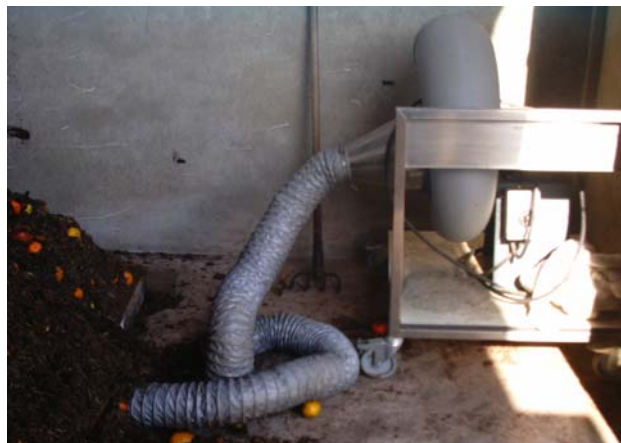
Figura 6: Ventilador instalado na pilha ventilada
