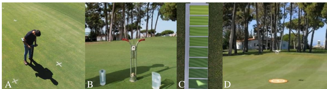
Figura 3.4. A) Medição da humidade do solo com o auxílio de uma sonda TDR; B) Medição da infiltração da água do solo; C) Registo da cor da relva, através da escala de cores; D) Levantamento do drone para a recolha de imagens nas diferentes bandas
