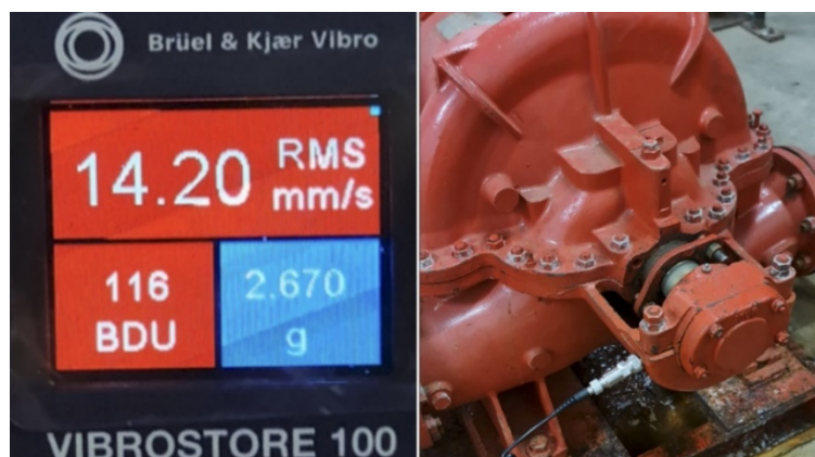
Figura 24 – Leitura do sensor na horizontal.
