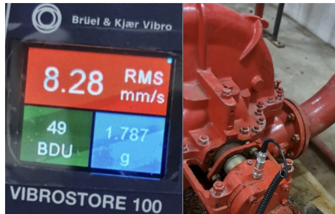
Figura 22 – Leitura do sensor na vertical.
