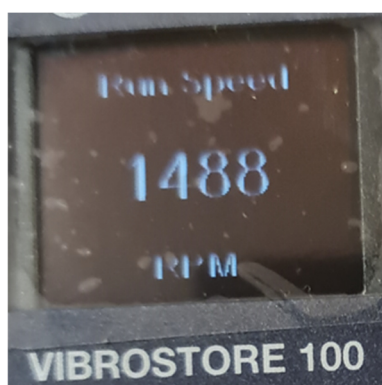
Figura 20 – Analisador de vibrações, seleção de RPM.
