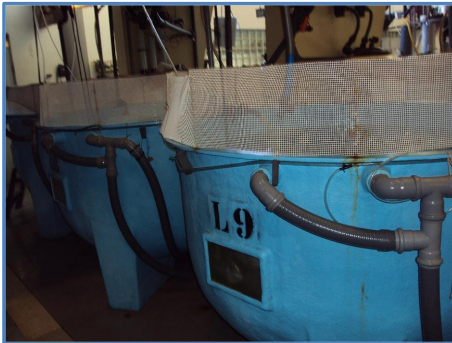
Figura 8 – Tanque de fibra de vidro com 1,5m 3 em sistema aberto de circulação de água.
