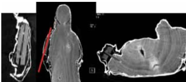
Figura 8 – Estudo por T.C. Reconstruções oblíqua (a), frontal (b) e transversal (c), onde se visualiza a prótese do braço direito, já fissurada (a) e uma das cavilhas de madeira de fixação da prótese ao corpo da Santa (c).
