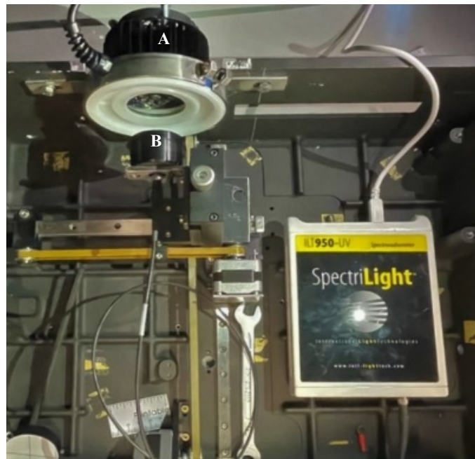
Figura 2.2 - Sistema de medição da intensidade da radiação emitida pelos LEDs, A- Reator UVLED (AquiSense Technologies, USA). B- Radiómetro (SpectriLight International Light Technologies ILT950-UV)
