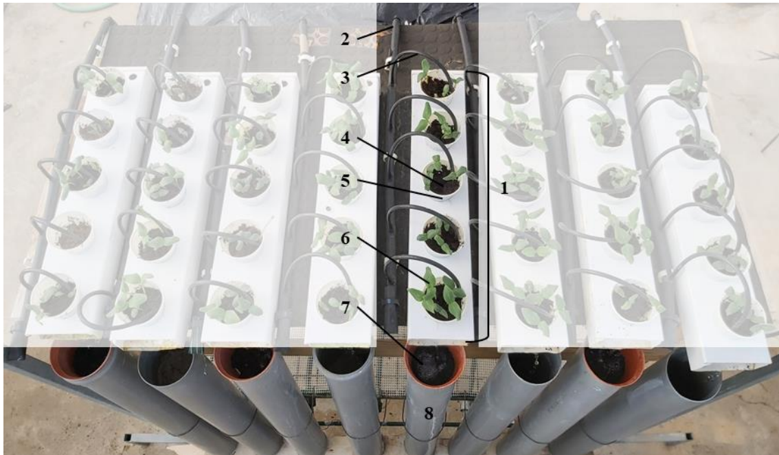
Figura 8.2 – Sistema de cultivo utilizado nos ensaios. 1 – calha de cultivo; 2 – tubo PE; 3 – microtubo; 4 – substrato; 5 – vaso; 6 – planta; 7 – vaso com patogénico, somente nas modalidades P + ; 8 – tubo PVC com filtro nas modalidades F + e sem filtro nas modalidades F - .
