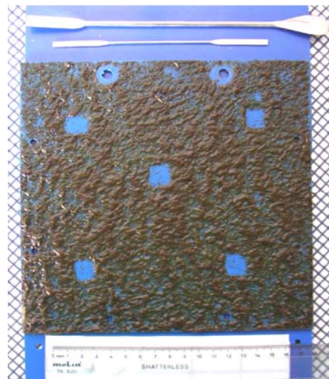
Figura 9 – Fotografia de um painel que mostra os pontos onde foram efectuadas as cinco raspagens de 1cm 2 . Em todos os painéis as raspagens efectuaram-se aproximadamente nos mesmos pontos.
