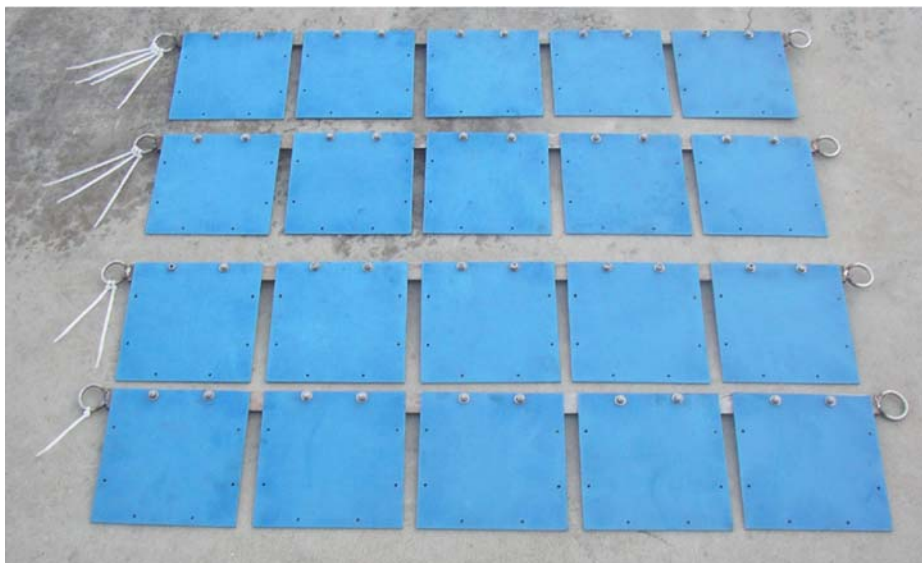
Figura 7 – Imagem que mostra 4 suportes, que consistem numa barra de aço inoxidável onde os painéis são aparafusados, de forma a resistir à força do mar a 2 metros de profundidade.
