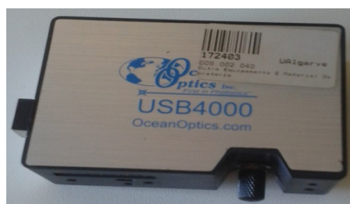
Figura 2.3: Espectrómetro USB4000 (Ocean Optics, EUA) utilizado para medições no visível.
