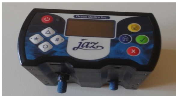
Figura 2.2: Espectrómetro JAZ (Ocean Optics, EUA) utilizado para medições do NIR.
