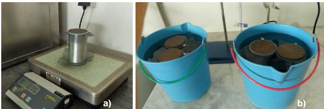
Fig. 3.7 – a) Pesagem das amostras recolhidas; b) Colocação das amostras em recipientes com água
