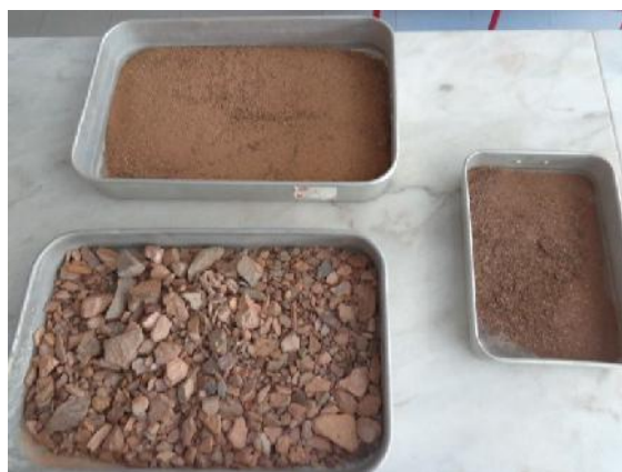
Fig. 3.4 – Fração de solo retida e passada no peneiro de 2.0mm
