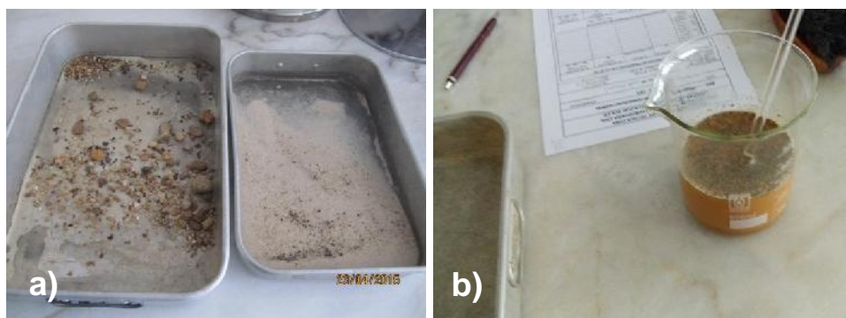
Fig. 3.3 – a) Fração de solo retida e passada, respetivamente, no peneiro de 2.0mm; b) Suspensão relativa ao material que passou no peneiro de 2.0mm
