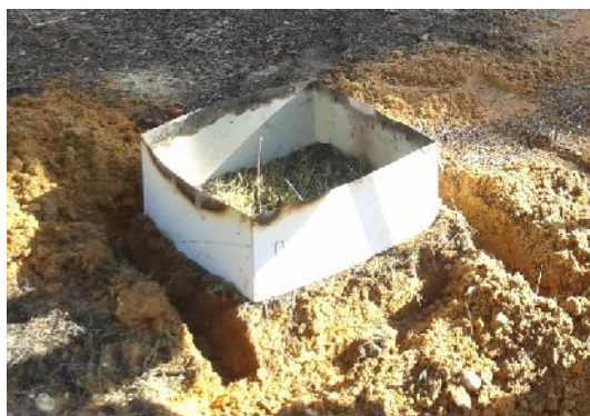
Fig.4.1 – Corte e confinamento lateral da amostra
