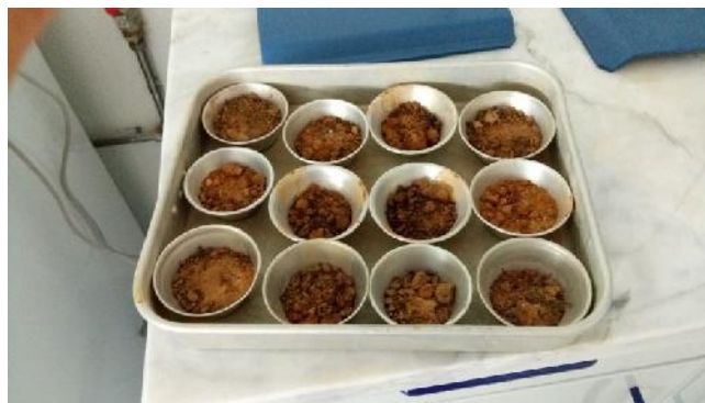
Fig. 3.2 – Amostras do solo utilizadas para a determinação do teor em água e da matéria orgânica
