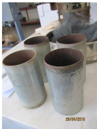
Fig. 3.5 – Amostradores cilíndricos utilizados na recolha das amostras
