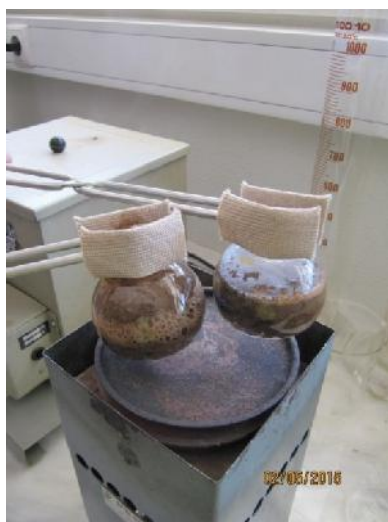
Fig. 3.9 – Aquecimento dos dois provetes para extração do ar
