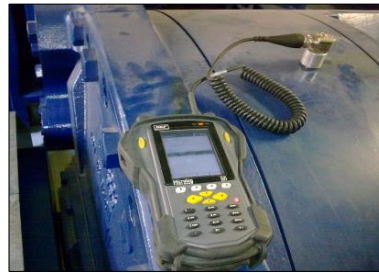
Figura 17.S Sistema portátil para aquisição de dados sobre vibrações (Teng et al., 2021)
