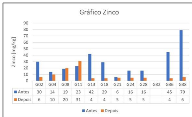
Figura 51. Concentração do zinco no óleo antes e depois das substituições das caixas multiplicadoras
